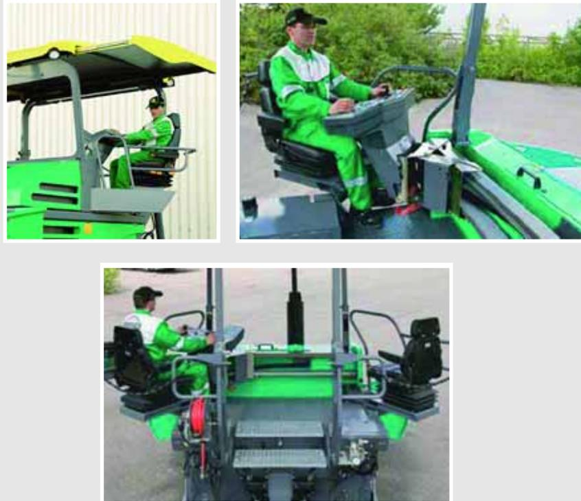
Figura 131: Nuevos diseños de cabina para mejorar la postura del operador y la visibilidad
