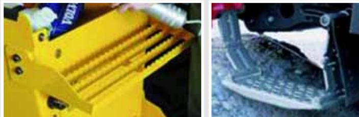
Figura 200: Escalón de diseño adecuado
