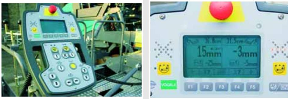
Figura 132: Sistemas de control de la nivelación
