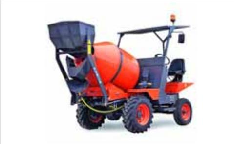
Figura 67: Camión y dúmper hormigonera
