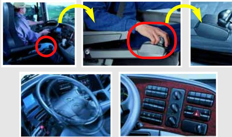
Figura 90: Novedades en el diseño de controles (cambio de marchas integrado en el asiento del conductor, volante regulable, agrupación funcional de los mandos y controles)
