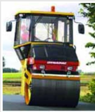
Figura 120: Nuevo diseño de cabinas para mejorar la visibilidad
