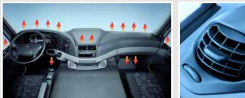
Figura 57: Sistemas de calefacción en las cabinas
