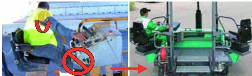
Figura 1: Ejemplo de diseño ergonómico para mejorar la postura del operador
