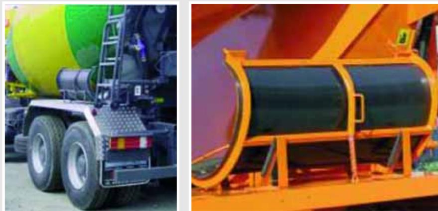
Figura 96: Hormigoneras con canaleta de fibra
