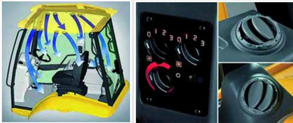
Figura 204: Sistemas De control de la temperatura
