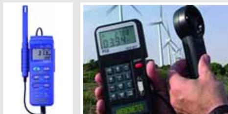
Figura 53: Termohigrómetro y anemómetro
