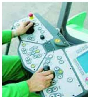
Figura 10: Diseño de controles y mandos de vehículos de obra civil
