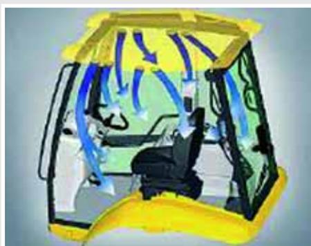
Figura 48: Cabinas con aire acondicionado
