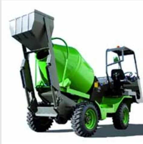
Figura 95: Dúmpper hormigonera con la cuba trasera
