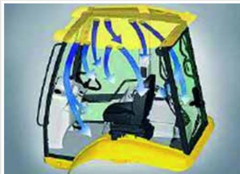
Figura 117: Diseño de los sistemas de climatización
