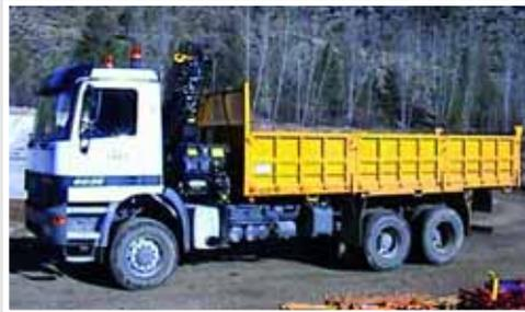
Figura 177: Camión autocargante
