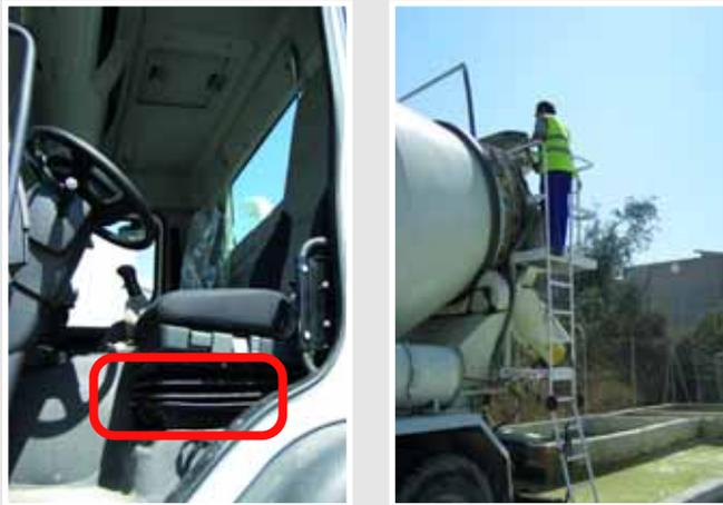
Figura 78: Asiento con suspensión neumática
