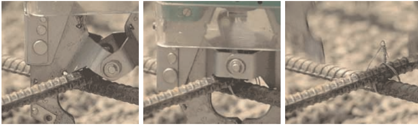
Figura 69 - Funcionamiento de una herramienta eléctrica para el atado de ferralla.
