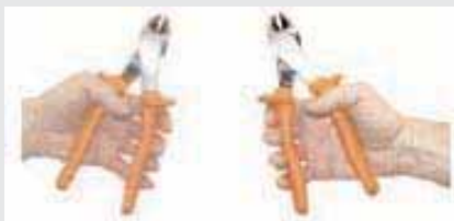
Figura 48: Herramienta que puede usarse con ambas manos
