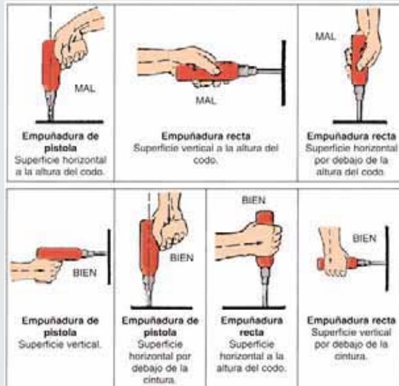
Figura 102: Tipo de empuñadura en función de la superficie de trabajo
