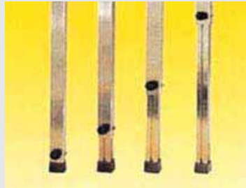
Figura 76: Patas telescópicas para regular altura de la máquina
