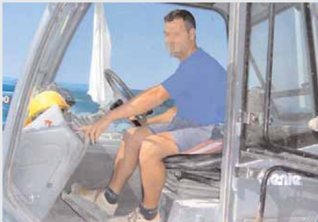
Figura 61: Postura de acceso a controles de uso poco frecuente
