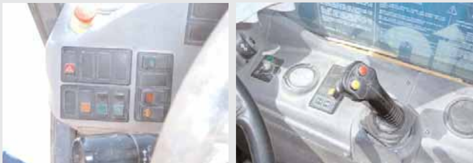
Figura 62: Diseño de controles en manipuladoras telescópicas
