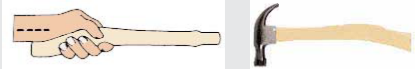
Figura 156: Nuevo diseño del mango para mejorar la postura de la muñeca
