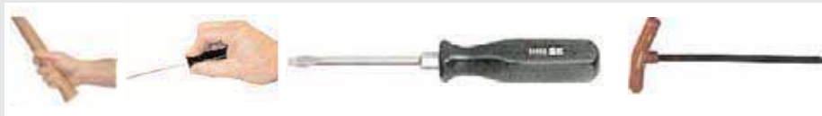
Figura 40: Diámetro del mango en función del tipo de herramienta
