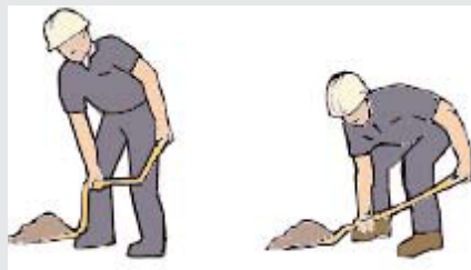
Figura 141: Mejora de la postura de trabajo con una pala de mango angulado
