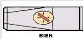
Figura 154: Unión adecuada de la cabeza el martillo
