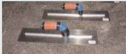
Figura 114: Recubrimiento del mango para evitar presiones intensas en la mano
