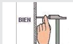
Figura 155: Uso adecuado del martillo
